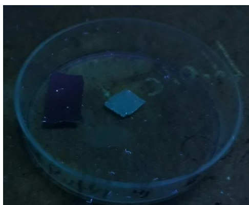
Figura 2. Membrana modificada polipropileno-almidón-puntos cuánticos.
