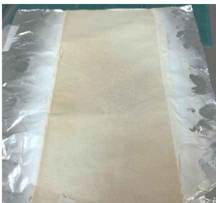
Figura 1. Foto de las membranas electrohiladas de PVC/Amberlyst® 15
