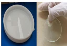
**Figura 1.** a) Solución PDMS-TEFS depositada en molde de teflón; b) Membrana polimérica curada.
