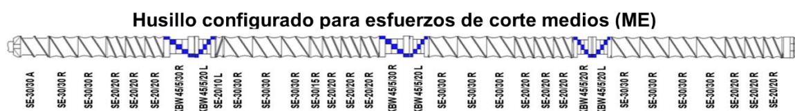
Figura 1. Diagrama de husillos modulares. Configuración medianos esfuerzo de corte (ME).
