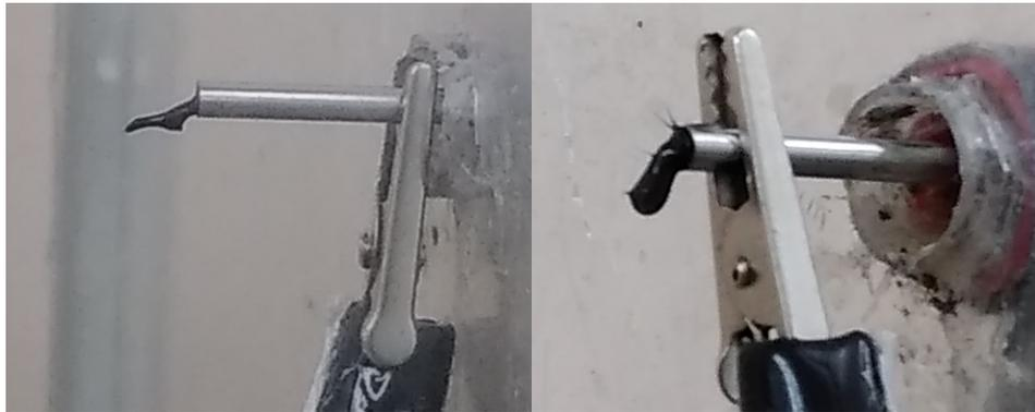
**Figura 3.** Síntesis de PCL (10%) Izq. Electrohilado de PCL (10%) sobre aluminio. Der. Electrohilado de PCL (10%) sobre tela de carbón.
