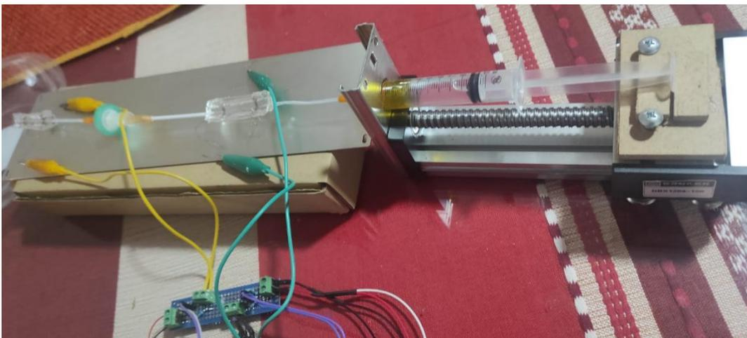
**Figura 4.** Dispositivo montado a manera modular para el monitoreo del fouling de membrana de nylon  $0.1 \mu\text{m}$  con solución de CMC  $0.04 \text{ mM}$  en tiempo real.
