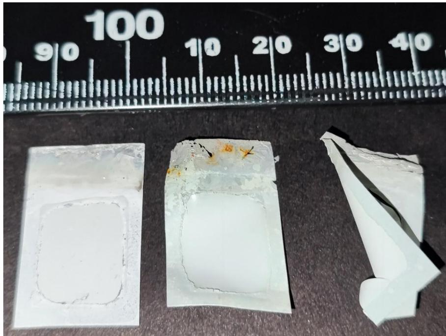
**Figura 4.** Imágenes ópticas de membranas de óxido de aluminio enmarcadas en el aluminio original. Extrema izquierda: membrana virgen, imagen central: placa recocida pero confinada entre dos substratos de cuarzo fundido durante el proceso, extrema derecha: placa recocida en estado libre; nótese la deformación por los esfuerzos mecánicos en el último caso.
