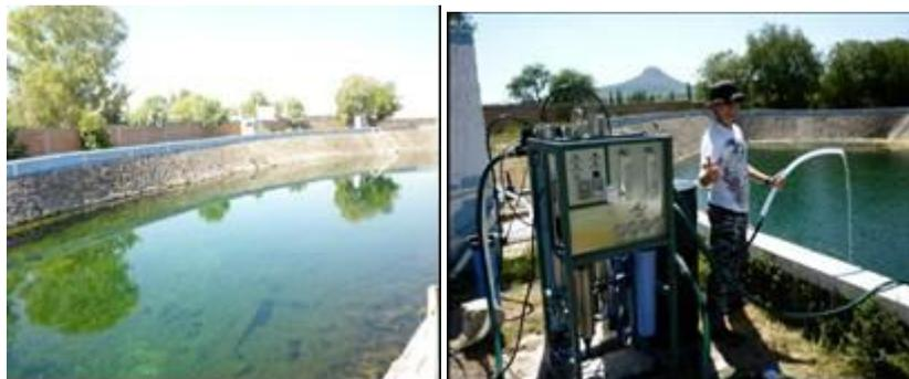
*Figura 1. Planta piloto de nanofiltración instalada junto al manantial.*
