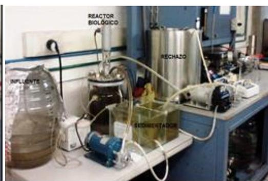
**Figura 2.** Biorreactor con módulo de membrana como proceso terciario (PT)
