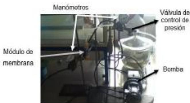
*Figura 2.1* Equipo de tratamiento de ultrafiltración con una membrana polimérica.
