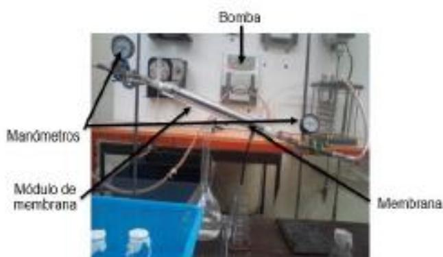
*Figura 2.2* Equipo de tratamiento de ultrafiltración con la membrana cerámica.
