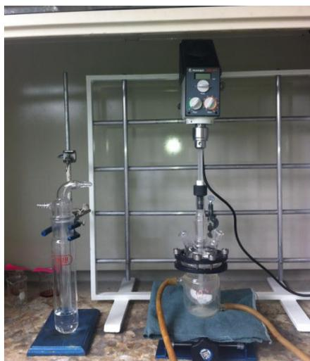
*Figura 1. Sistema de reacción usado para la síntesis de la resina fenólica.*
