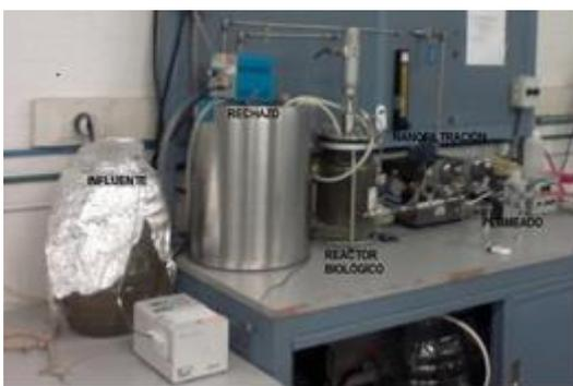
**Figura 1.** Biorreactor acoplado al módulo de membrana en configuración de membrana externa (MBR)
